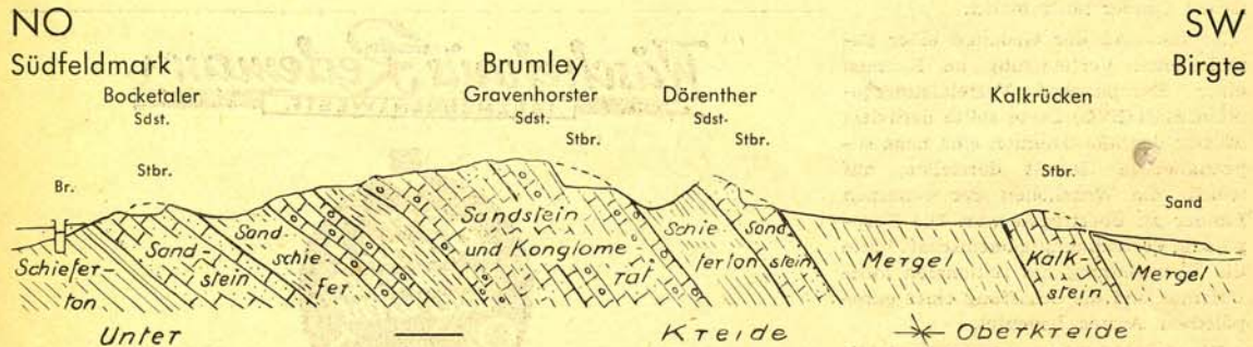
Abb. 1 Querprofil durch den Teutoburger Wald auf der Linie Ibbenbürener Südfeldmark-Brumley-Birgte Sdt. = Sandstein Stbr. = Steinbruch Br. = Brunnen
